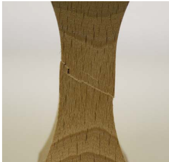
Abb. 6.1: Typisches Schubversagen einer Druckprobe bei Belastung in Faserrichtung.
