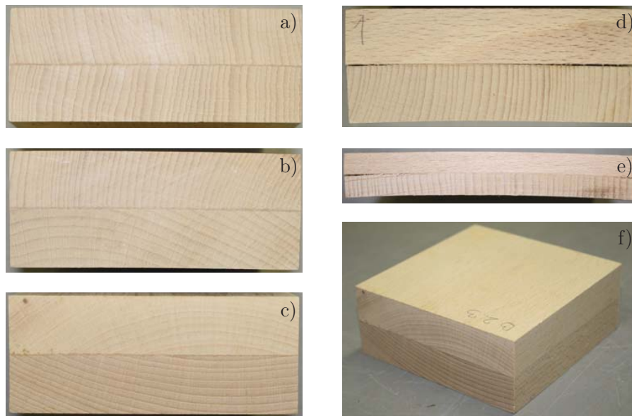
Abb. 7.31: Schichtvariationen im Delaminationsversuch unter Lufttrocknung. Faserparallele Verklebungen (Gesamtdicke = 40mm): a) stehend/stehend, b) stehend/liegend, c) und f) liegend/liegend; kreuzweise Verklebungen: d) Gesamtdicke = 40mm und e) Gesamtdicke = 15mm.
