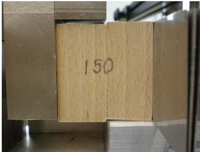
Abb. 6.3: Standardisierter Scherversuch nach DIN 52187 mit versagter Würfelprobe (L-R Scherebene) und Distanzscheiben (rechts) zum Ausgleich von Quell- und Schwinderscheinungen bei der Ermittlung feuchteabhängiger Scherfestigkeiten.
