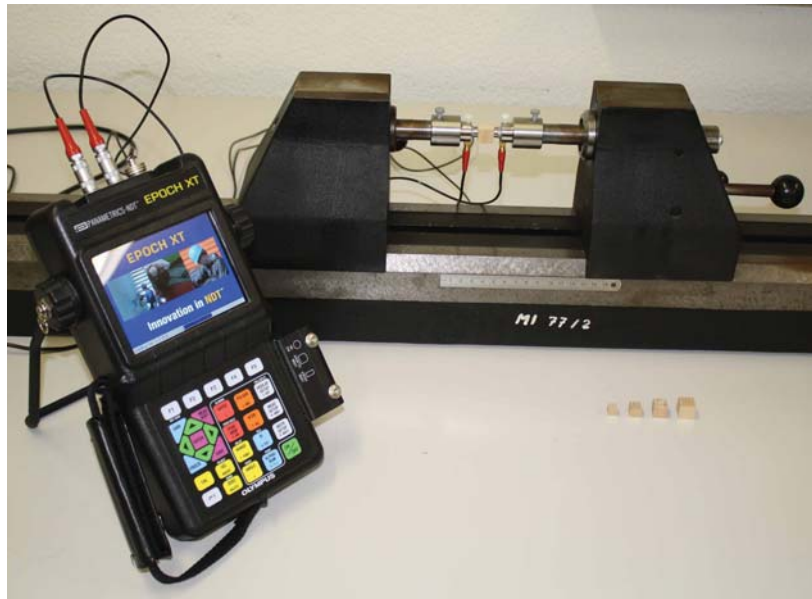
Abb. 4.8: Ultraschallprüfgerät EPOCH XT mit Sensoreinspannvorrichtung und Würfelprouben der Ultraschalluntersuchungen.
