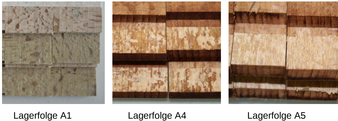
Abb.: 5.2 Bruchbild der Lagerfolgen nach EMIMAc Behandlung
