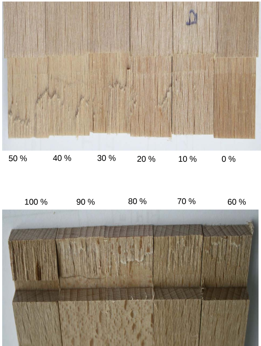
Abb.: 4.4 Visuelle Einschätzung des Holzausriss
