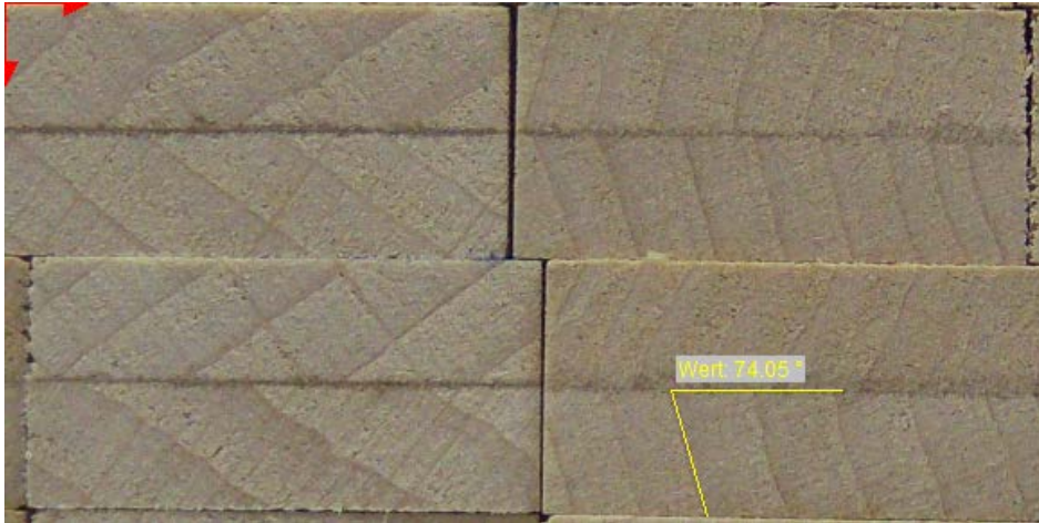
Abb.: 3.1 Beispiel für die Jahrringwinkelbestimmung
