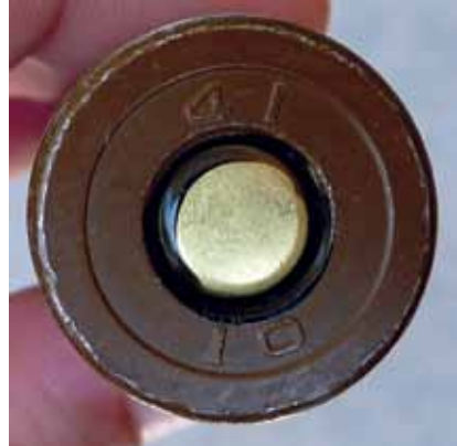
الصورة ٣: ذخائر مصنع ٤١ عيار ٧، ١٢ × ١٠٨ ملم منتجة في العام ٢٠١٠ وتم توثيقها في حوزة حركة/جيش تحرير جنوب السودان في الوحدة، جنوب السودان، مايو/أيار ٢٠١٣. © جونا ليف
