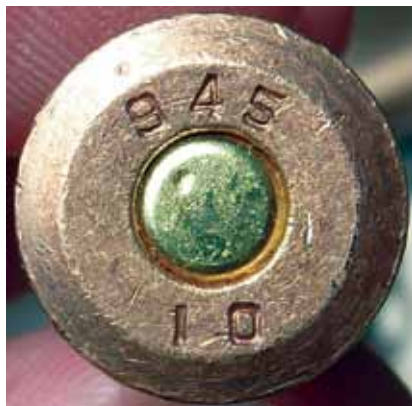
الصورة ٤: خرطوش من المصنع ٩٤٥ عيار ٧,٦٢ X ٥٤ آر ملم منتج في العام ٢٠٠٩ وتم العثور عليه في مغلف سوداني. استولى الجيش الشعبي لتحرير السودان على طلقات من الحركة /الجيش الديمقراطي لجنوب السودان التابعة أنور في مارس/آذار ٢٠١١. جونقلي، جنوب السودان. أبريل/نيسان ٢٠١١. © جون ليف
