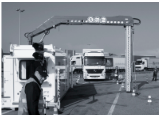
Lastwagen-Scanner. Mit mobilem LKW-Scanner lassen sich Zollkontrollen schnell und wirkungsvoll durchführen. FOTO EIDG. ZOLLVERWALTUNG
