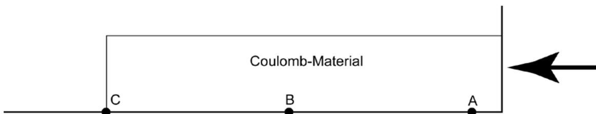
Die Spannung an Punkt A),  $\sigma_{1A}$ , beträgt 216 MPa.
